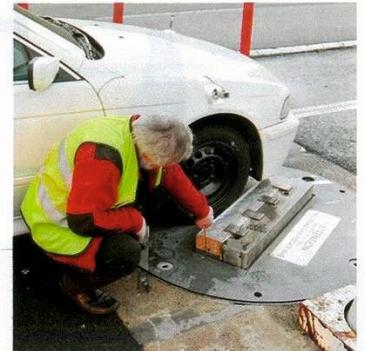
Высота бордюра — 78 мм, давление в зачетной шине — 2 бара
