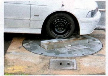
При наезде на бордюр шина сминается до самого обода. Обод усиленный — если проводить испытания на стандартных колесах, их пришлось бы менять после теста каждой шины
