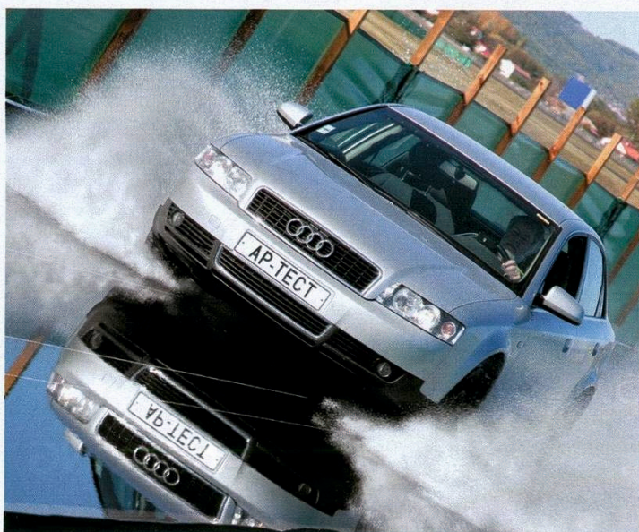
Испытания на сопротивление шин аквапланированию мы проводили на Audi A4, оборудованном специальной аппаратурой. Автомобиль, попав в ванну с восьмимиллиметровым слоем воды, разгоняется с максимальной интенсивностью до полной потери контакта ведущих колес с дорогой. Скорость автомобиля, при которой аппаратура фиксирует 10-процентную пробуксовку колес, идет в итоговый протокол
