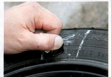
Сквозной пробой боковины — такие повреждения шин знакомы всем российским водителям
