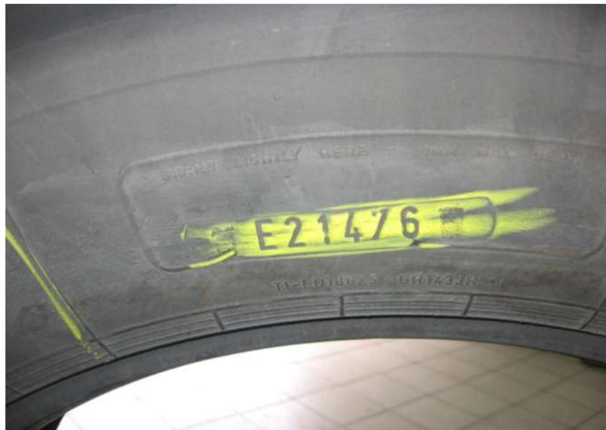
РИС. 2. Номер каркаса
